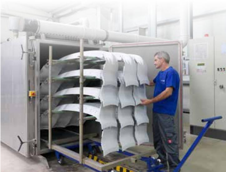
In Halle 7 im Werk 2 steht eine Reaktorkammer, in der unter Vakuum mit einem Fluor/Stickstoff-Gemisch Kunststoffbauteile behandelt werden.
